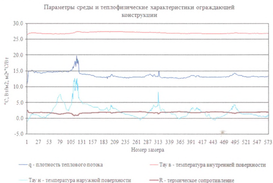
Рисунок 12. Теплофизические характеристики зарадиаторных участков наружных стен до установки отражающих экранов
